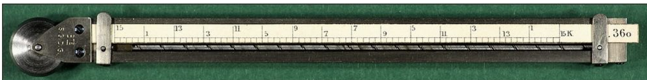
Une roulette dentée de 50 mm de circonférence (pour ne pas glisser sur le papier), entraîne à l'aide d'un engrenage une vis, un écrou muni d'un index se déplace en face de l'échelle.
