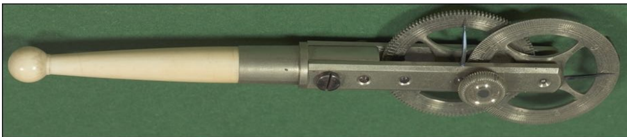
Une autre version commercialisée par CABASSON, mais aussi par MORIN vers 1910. Un perfectionnement est à signaler, une vis à tête moletée agissant sur une lamelle d'acier freinait la roulette lorsqu'elle était soulevée du papier, réduisant les sources d'erreur.
