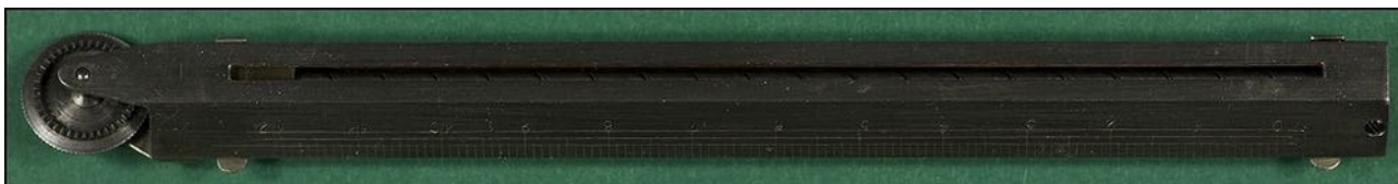
Une roulette dentée de 50 mm de circonférence (pour ne pas glisser sur le papier), entraîne à l'aide d'un engrenage une vis, un écrou muni d'un index se déplace en face de l'échelle.
